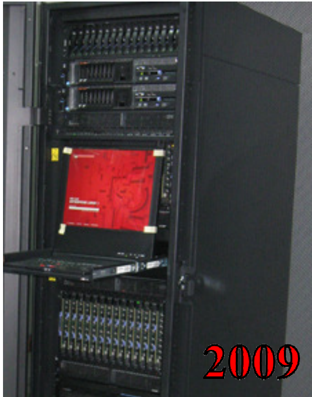
High Performance Computer Lab IBM BladeCenter Cluster cu 96 de procesoare, ajungând la o putere de calcul de 6.45 Tflops.
