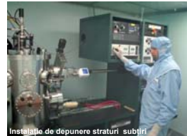
Instalație de depunere straturi subțiri
