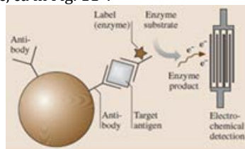
Fig. 11. Ilustrarea conceptului biodetectiei electrochimice: anticorpii marcati magnetic retin antigenii ce trebuie detectati pe care se fixeaza un al doilea rand de anticorpi marcati cu enzime ce pot furniza un semnal daca se afla in zona unei grile de detectie electrochimica.
