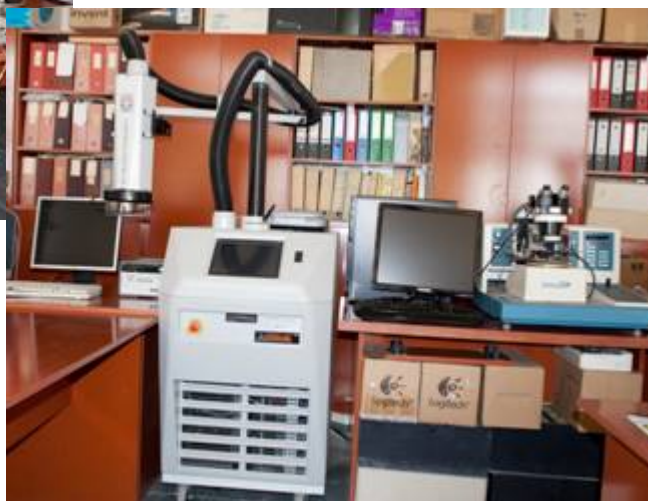
Echipamente de caracterizare electrica din cadrul laboratorului de fiabilitate din IMT-Bucuresti (Echipamante Keithley, Tempronic)
