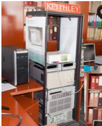
Echipamente de caracterizare electrica din cadrul laboratorului de fiabilitate din IMT-Bucuresti (Echipamante Keithley, Tempronic)
