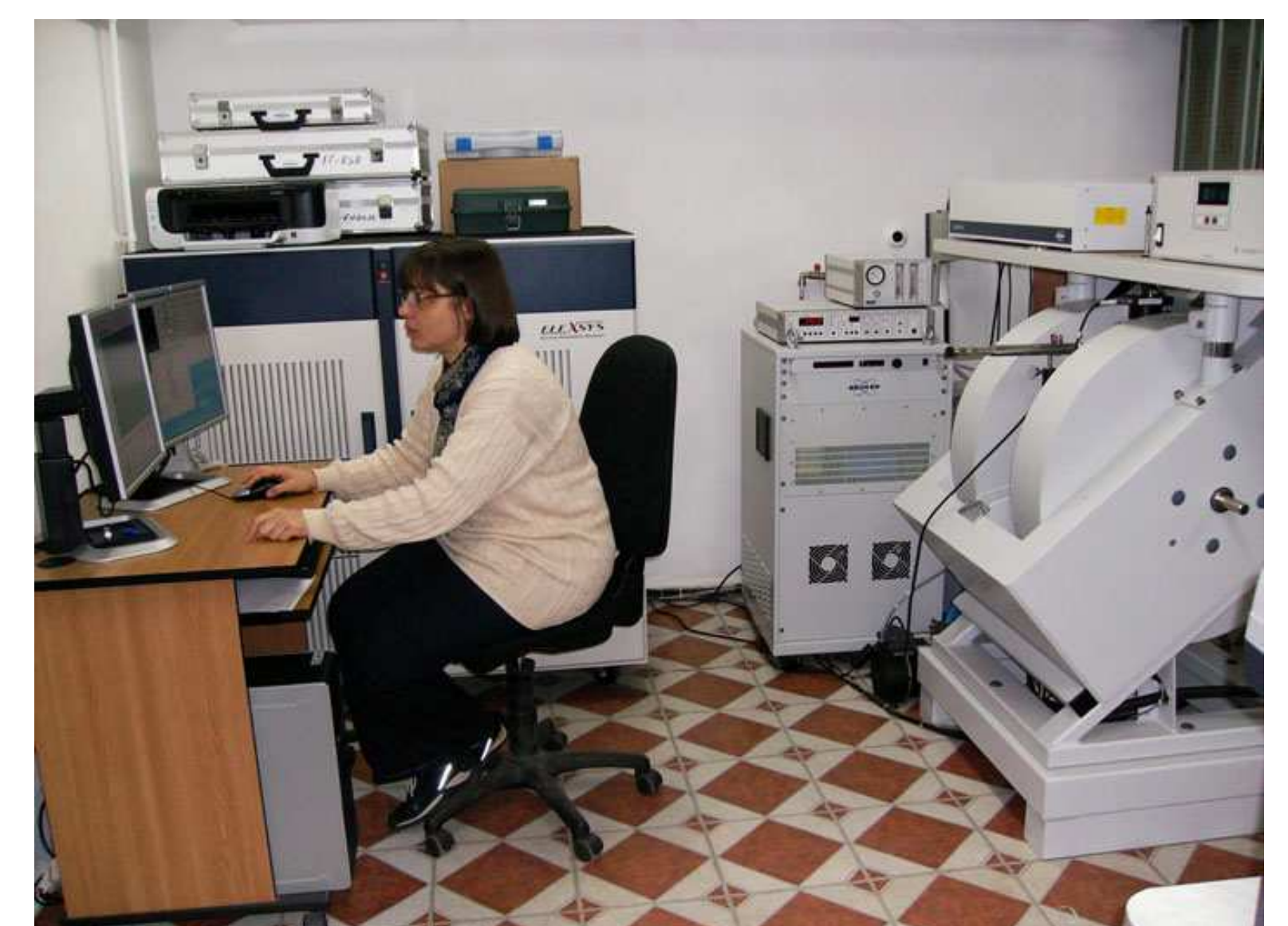
Spectrometru RES in banda X in pulsuri, model Bruker ELEXSYS E580, echipat cu module ENDOR/ELDOR - unicul din Romania-
