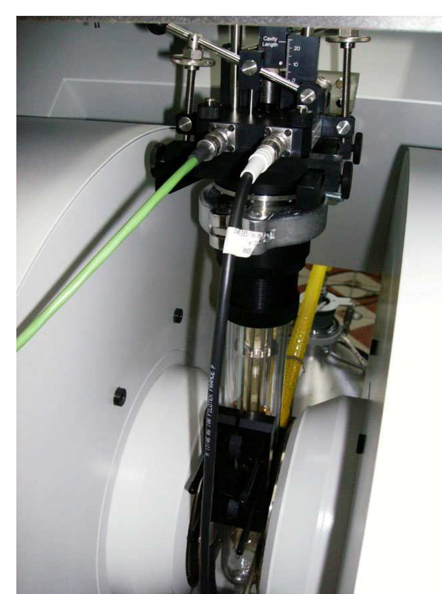
Spectrometru RES in banda Q in regim continuu, model Bruker ELEXSYS E500Q echipat cu modul ENDOR
