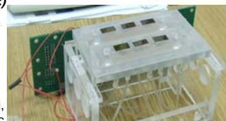
Arie de 6 imunosenzori, conectati intr-un modul fluidic
