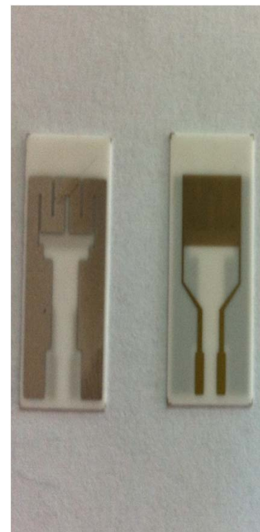
Senzori pe substrat ceramic: poza spate, respectiv fata a cip-ului
