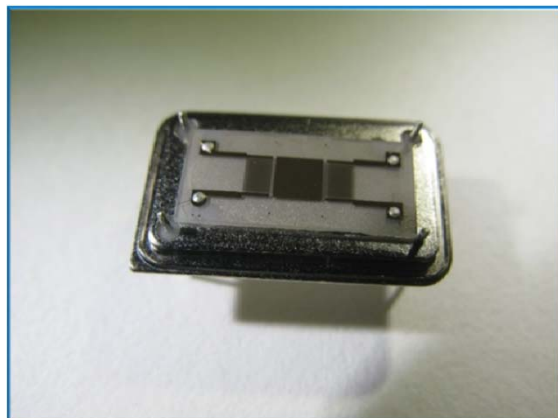
Dispozitivul SH SAW incapsulat pe substrat de \text{LiTaO}_3
