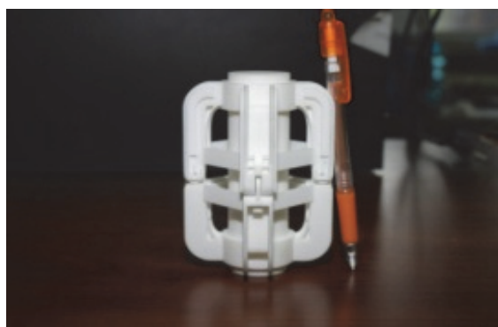
Demonstrator de senzor de torsiune făcut pentru verificarea principiului de detecție, depanabilității și identificării problemelor care pot apare la utilizarea sa. Varianta miniaturizată a fost fabricată ulterior prin 3D Printing pe metal.
