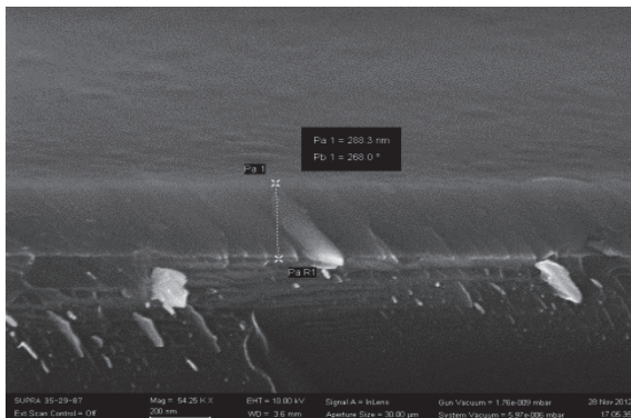
Plachete de siliciu de 4 inch cu film de nitrură depus; imagine SEM în secțiune a unui film de nitrură (283nm) depus pe placheta de siliciu.
