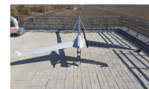
Arie de celule fotovoltaice texturate amplasate pe aripa ultrașoară a unui avion din UAV Hirus, aflat pe rampa de lansare
