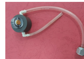
Micrografie SEM cu NT (nanotuburi) de TiO 2 obținute prin anodizarea foliei de Ti. Imagine a senzorului fixat in soclul utilizat pentru testare in camera de gaze
