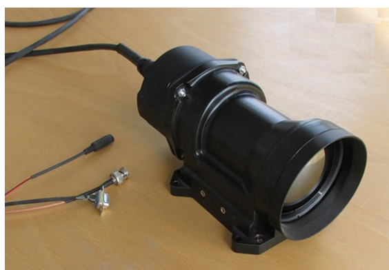
Sistemul SOFID realizat de Pro Optica impreuna cu un detector LWIR fara racire SOFID - sistem optic pentru domeniul spectral LWIR
