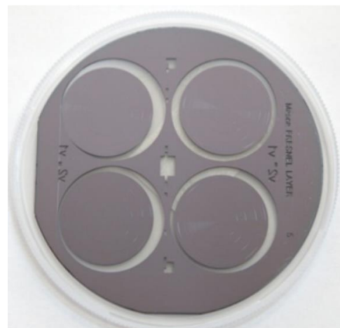
Imaginea elementului optic difractiv obținută prin interferometrie de lumină albă (stanga); imaginea lentilelor Fresnel separate de pe placheta de siliciu prin utilizarea procesului Bosch (dreapta).
