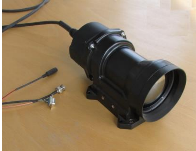
Sistemul SOFID realizat de ProOptica, având în componență un detector LWIR fără răcire
