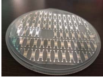
Procesarea tehnologică: lot prototip senzori SAW
