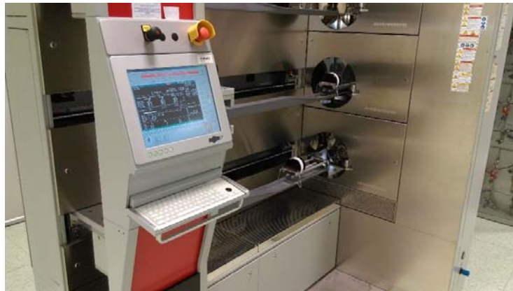
Echipament Centrotherm E1200 cu tuburi de difuzie dedicate
