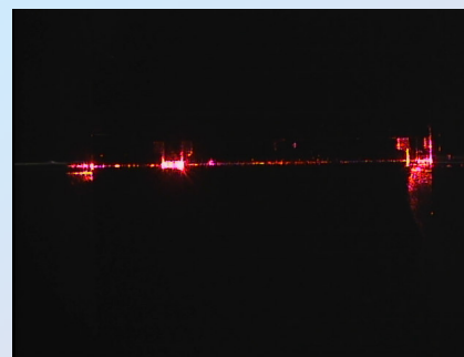
Propagarea radiatiei prin ghidurile de unda utilizate pentru conexiuni optice optice intra-cip
