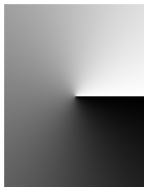
Fig. 3 Masca de faza utilizata pentru expunerea la UV in vederea obtinerii structurii de vortex optic.
