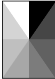
Fig.1 Schema structurii spirale cu diferenta de faza de 2\pi care genereaza un vortex cu un numar orbital OAM=1
