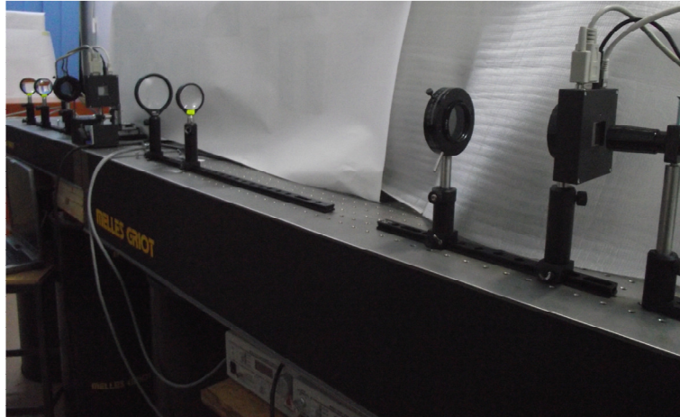
Fig. 17 Montajul experimental realizat pe masa holografica. Primul SLM joaca rolul de transmitator iar cel de al doilea, joaca rolul de receptor
