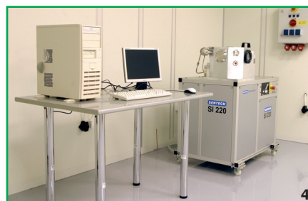
Echipamentul de corodare cu ioni reactivi (RIE) instalat în noua camera alba din IMT, pusă la dispoziția parcului.
