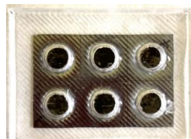
Incapsularea biochip-ului in matrita din PDMS
