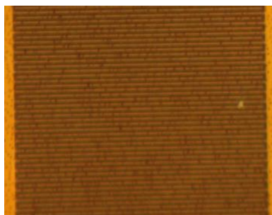
Imagine la microscopul optic a probei realizata pe film subtire de YBCO – detaliu -se poate observa structura rezistorului de tip meandre cu latimea de 200 nm.
