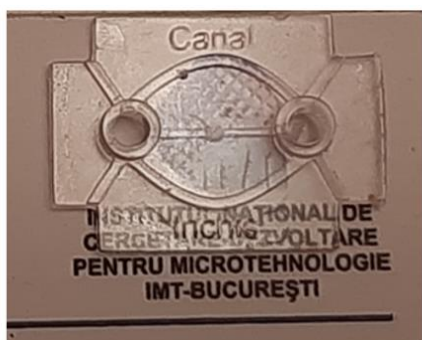
Componenta fluidica si suport realizate din rasina transparenta
