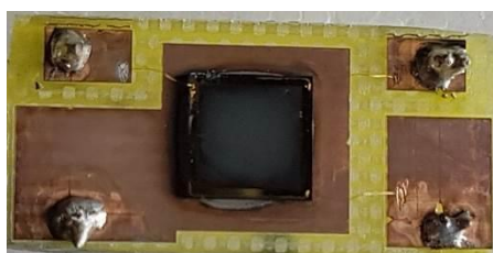
Dispozitiv pe baza de heterojonctiune AgNWs/SiNHs pentru fotodetectie in domeniul Vis-NIR
