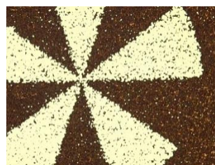
Imagine de microscopie optica a unui element optic difractiv binar configurat in fotorezist cu sistemul fotolitografic bazat pe modulatorul spatial de lumina
