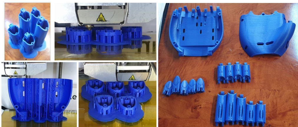
Prototipare rapida cu ajutorul tehnologiei FDM
