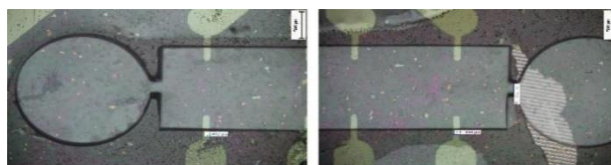
Imagină optică pentru canalul microfluidic PDMS peste traductoarele ITO
