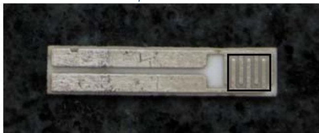
Senzor chemirezistiv de detectie etanol la temperatura camerei pe baza de strat senzitiv preparat din pulberi de ZnO-nanohornuri cu ZnO obtinut prin sonochimie si nanohornuri comerciale. Stratul senzitiv s-a depus in interiorul dreptunghiului desenat pe structura interdigitata.
