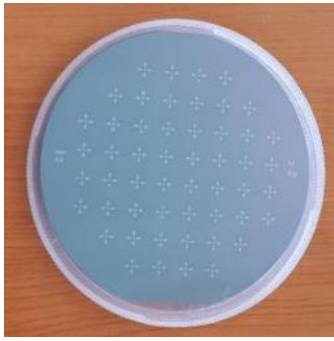
Fotografie a unei plachete de Si procesate, (spate). Sunt vizibile ferestrele deschise in oxid pentru corodare anizotropă.
