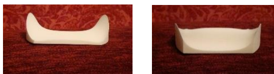
Imagine fotografica din mai multe unghiuri a elementului optic free form nr. 2, varianta “negativa”
