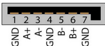
Figura 9: Proiectul senzorului cu cele 4 măști suprapuse, pinout-ul corespunzător USB SATA II male precum și schita lui tehnică
