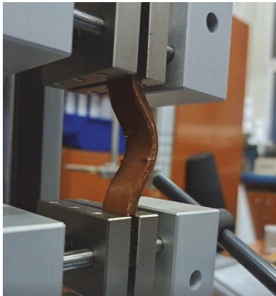
Figura 3 : Verificari la indoiri repetate. Proba PDMS acoperita cu grund speciala indoita - inceput test si supusa in continuare la cicluri de indoire repetata ( 50 cicluri)
