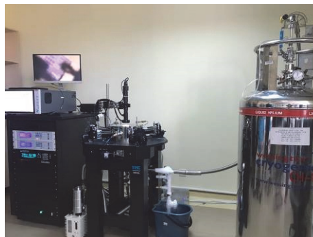
Echipament Criogenic pentru masurarea caracteristicilor d.c. si de microunde, in camp magnetic (2,5T), pana la 2 grade Kelvin
