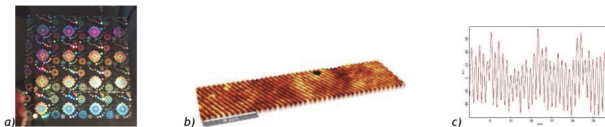
a) Imaginea holografica pe shim-ul de lucru; b) topografie element difractiv din componenta imaginii holografice; c) profil a unei secțiuni din topografia investigată
