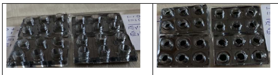
Structuri de SiNWs încapsulate în PDMS
