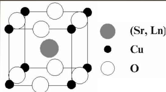
$Sr_{1-x}Ln_xCuO_2$ ;  $T_{c,max} = 43 K$
